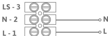
Câblage avec temporisation et interrupteur
