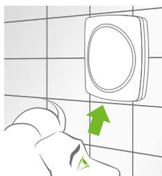
La lecture des différents paramètres (défilement automatique) se fait à travers le prisme avec la façade en place et s'éteint après 15 minutes : débit réel en cours (XXX), pression de fonctionnement (XXP) et taux d'humidité dans la pièce (XXH)
