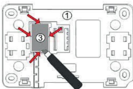
Con una herramienta afilada, haga cuatro orificios en la tapa (3) para los terminales de tornillo.
