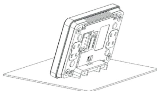
Para colocar el panel de control sobre una superficie plana, utilice un soporte específico.
