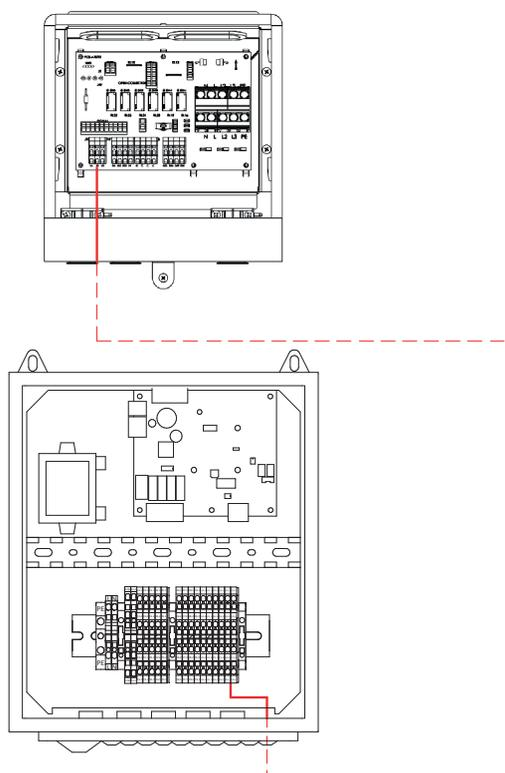
**Bloque de terminales del módulo externo:**
