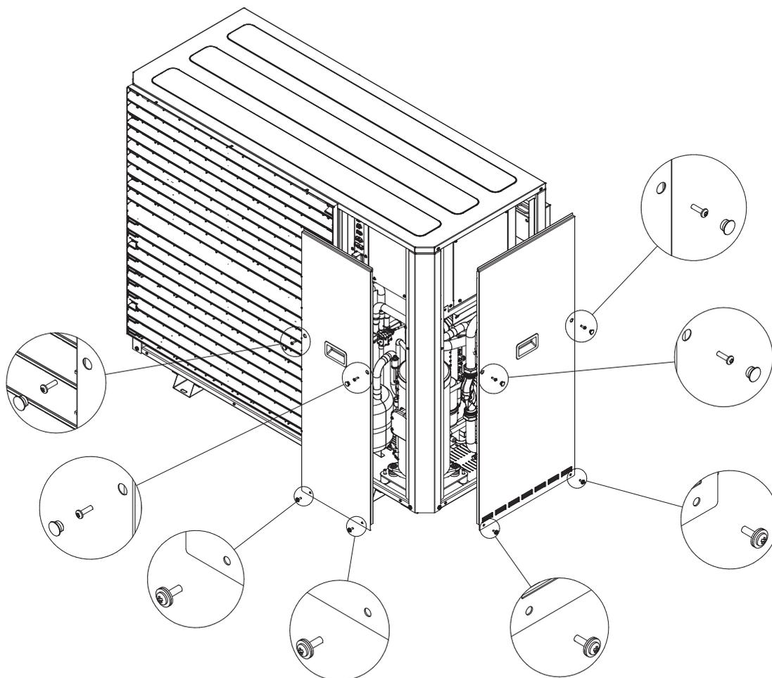
Retire los dos paneles de acceso al compartimento de componentes desatornillando los tornillos como se muestra en la Figura 1.
