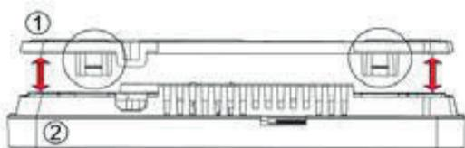
Desconecte el soporte de montaje (1) de la parte posterior de la carcasa del termostato ambiente (2). El soporte está fijado a la carcasa del panel mediante pestillos. Utilice un destornillador plano para separar el soporte.
