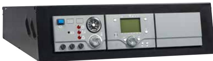
Disponible en option sur les gammes LR et LRK, le tableau de commande NAVISTEM B2000 assure le pilotage d'un brûleur 1 / 2 allures ou modulant ainsi que la régulation de plusieurs circuits secondaires. Il est fourni prêt à être raccordé, selon les options choisies. L'ensemble, protégé par un coffret en acier, se monte facilement sur le dessus de la chaudière, sur le support fourni. Composé d'un module thermostat et d'un régulateur regroupés au sein d'un même tableau, il vous apporte :
