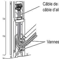
Acheminez le câble de raccordement et le câble d'alimentation à l'arrière de l'unité extérieure entre les 2 vannes comme indiqué dans la figure. (Pour installer facilement le couvercle du commutateur.)
