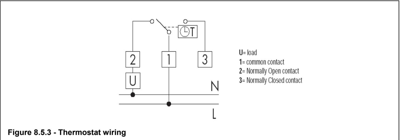
**Figure 8.5.3 - Thermostat wiring**
