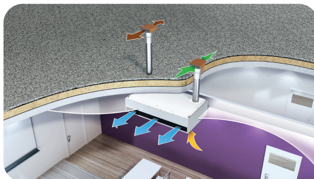
Entrée d'air et rejet en toiture
