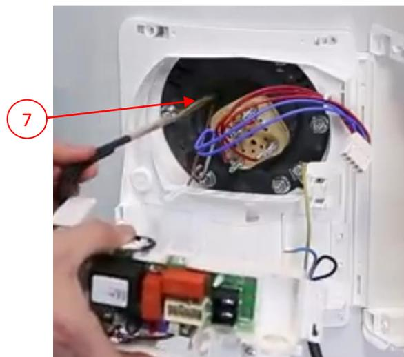
7- Mettre en place le nouveau thermostat électronique et tout remonter en suivant les étapes dans l'autre sens
