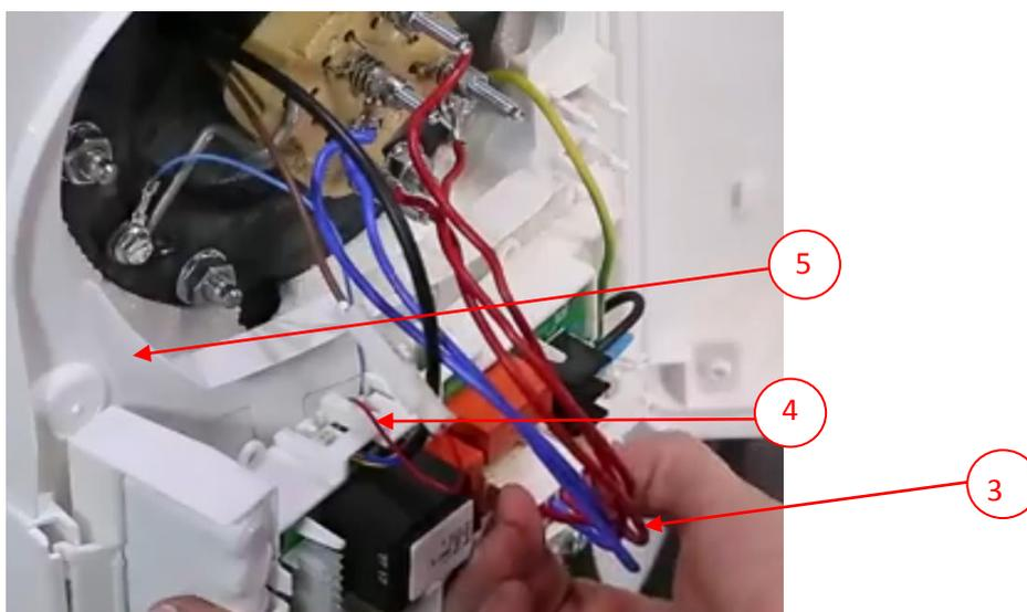
6- Retirer le thermostat 6 en le soulevant légèrement et sortir la sonde de régulation 7
