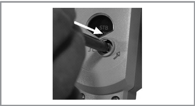
Figure 5 - Réarmement du thermostat de sécurité
