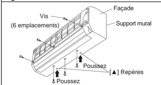
3. En plaçant les mains sur la partie inférieure de la façade, appuyez avec les pouces aux endroits marqués avec des repères [▲] afin de la dégager en la soulevant vers vous.
