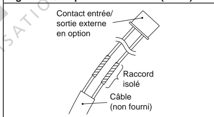
**Important :** Veillez à souder les câbles et à isoler la connexion entre les fils.
