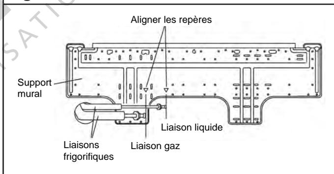
Après avoir fait passer les liaisons de l'unité intérieure et le tuyau d'évacuation dans l'orifice pratiqué dans le mur, placez le climatiseur dans les crochets du support mural du haut, insérez les deux crochets du bas dans les trous de fixation correspondants et abaissez celui-ci en le repoussant contre le mur. (Fig. 15).
