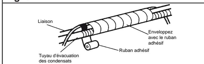
**Fig. 35 - Sortie gauche ⑤ et arrière gauche ④**
