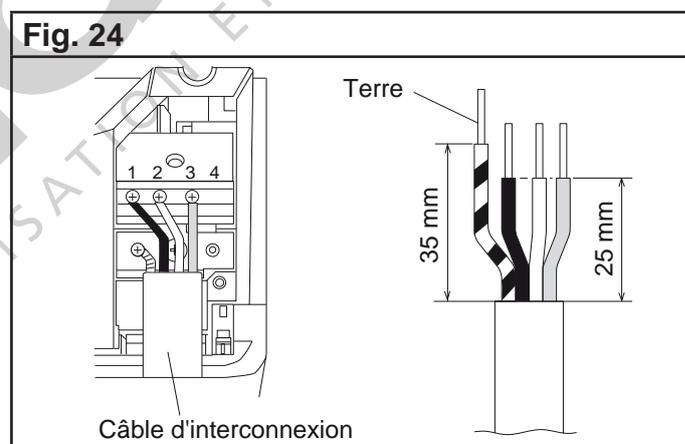
4. Fixez le câble avec un serre-câble. Remettez le cache bornier en place en insérant la languette dans le trou carré et fixez la vis.
