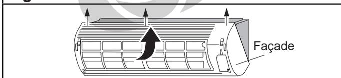
2. Ensuite, insérez la partie supérieure de la façade. (Insérez les 2 crochets supérieurs de la façade dans les trous approprié à l'avant du châssis.)
