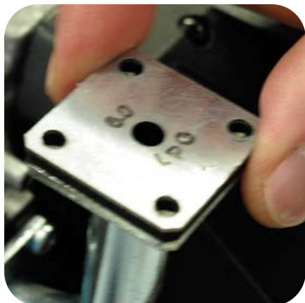
9-Insérer le diaphragme calibré 6.0.
