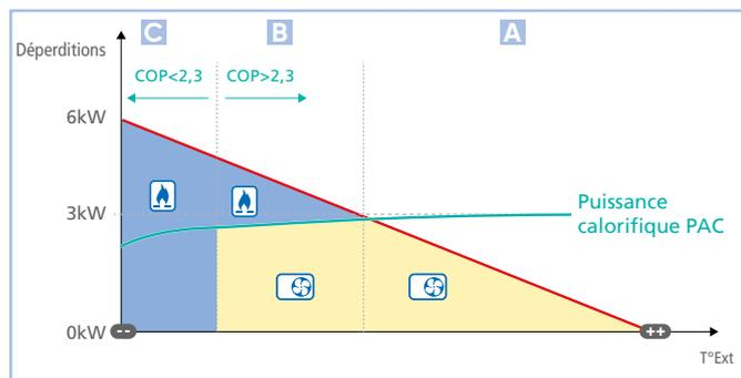
Grâce à son COP performant même à faibles températures, la PAC continuera de fonctionner jusqu'à -3,2 °C\* de température extérieure en configuration plancher chauffant et jusqu'à -2,2 °C\* en configuration radiateurs 45 °C.
