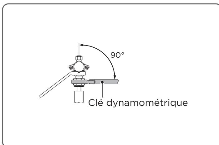
**10.** Pour une meilleure étanchéité effectuer un double serrage (serrer une fois au couple puis desserrer puis resserrer de nouveau au couple). Pour éviter les risques de fuites de gaz et assurer un serrage facile huiler les portées et les filetages à l'huile frigorifique compatible R32. Ne pas utiliser d'huile minérale.
