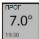
Если вы установили температуру Антисамерзание (7°C), то при переходе в диапазон программирования в режиме ECO на дисплее появляется 6°C (автоматическое снижение на 1°C)
