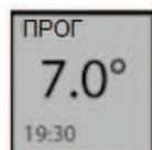
Εάν έχετε ρυθμίσει τη θερμοκρασία του σημείου ψύξης (7°C), τότε στην αλλαγή στο προγραμματισμό στη λειτουργία ECO στην οθόνη εμφανίζεται 6°C (αυτόματη μείωση για 1°C).
