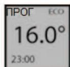
Εάν στην οθόνη εμφανίζει PROG ECO, μπορείτε να ρυθμίσετε το εύρος του προγραμματισμού στη λειτουργία ECO. Για να αλλάξετε τη θερμοκρασία στη λειτουργία ECO, θα πρέπει να πάτε στο μενού Temp. ECO (βλέπε την παρ. «Μενού στη λειτουργία PROG»)
