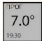
Якщо ви встановили температуру Антирамерзання (7°C), то при переході до діапазону програмування у режимі ECO на дисплеї з'являється 6°C (автоматичне зниження на 1°C)
