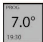
Ha beállította a Fagytól való védelem hőmérsékletet (7°C), az ECO üzemmódbani programozásra való átálláskor, a kijelző 6°C-ot mutat (1°C-ra történő automatikus csökkentés)
