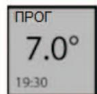
Ако е установена температура Антизамръзване (7°C), то при прехода към диапазон на програмиране в режим ECO на дисплея се появява 6°C (автоматическо намаляване на 1°C).
