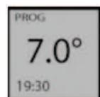
Če ste nastavili temperaturo proti zamrznitvi (7°C), po prestopu na način programiranja ECO na zaslonu se pojavi 6°C (samodejno znižanje za 1°C).
