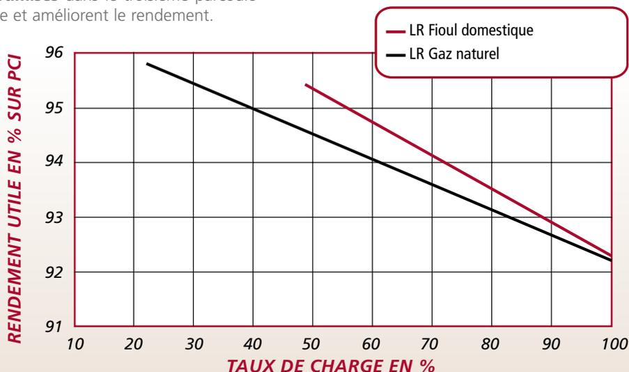
Les rendements utiles sont donnés pour un taux d'excès d'air de 20 % au fioul domestique ( $\text{CO}_2$  de 12,7 %) et un taux d'excès d'air de 15 % au gaz naturel ( $\text{CO}_2$  de 10 %).
