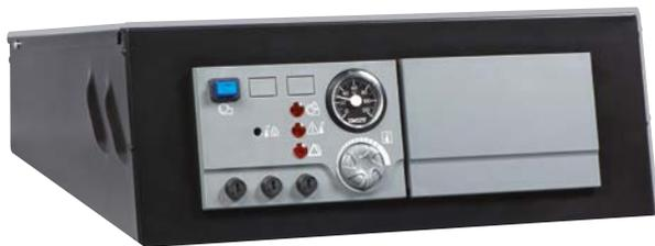
Disponible en option sur les gammes LR et LRK, le tableau de commande NAVISTEM B1000 permet de piloter le brûleur de la chaudière à l'aide d'un thermostat de régulation à deux allures (se réglant à partir de la même molette, selon un différentiel fixe de 6°C). Il est fourni prêt à être raccordé, selon les options choisies. L'ensemble, protégé par un coffret en acier, se monte facilement sur le dessus de la chaudière, sur le support fourni.
