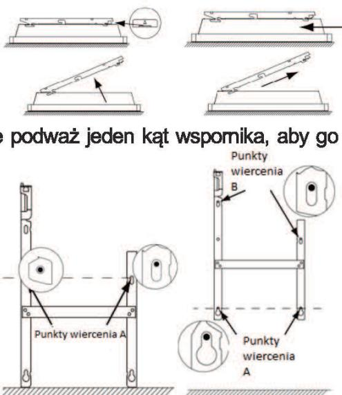
wiercenia A dla dolnych mocowań wspornika. Podważ wspornik, łącząc oznaczenia z dolnymi otworami wspornika, po czym zaznacz dwa miejsca, które pozostały dla górnych otworów wspornika (B) Wywiercić 4 otwory i zamocuj wspornik do ściany za pomocą kołków rozporowych. Używaj kołki rozporowe, odpowiednie do powłoki ściennej (np. gipsowo-kartonowe).
