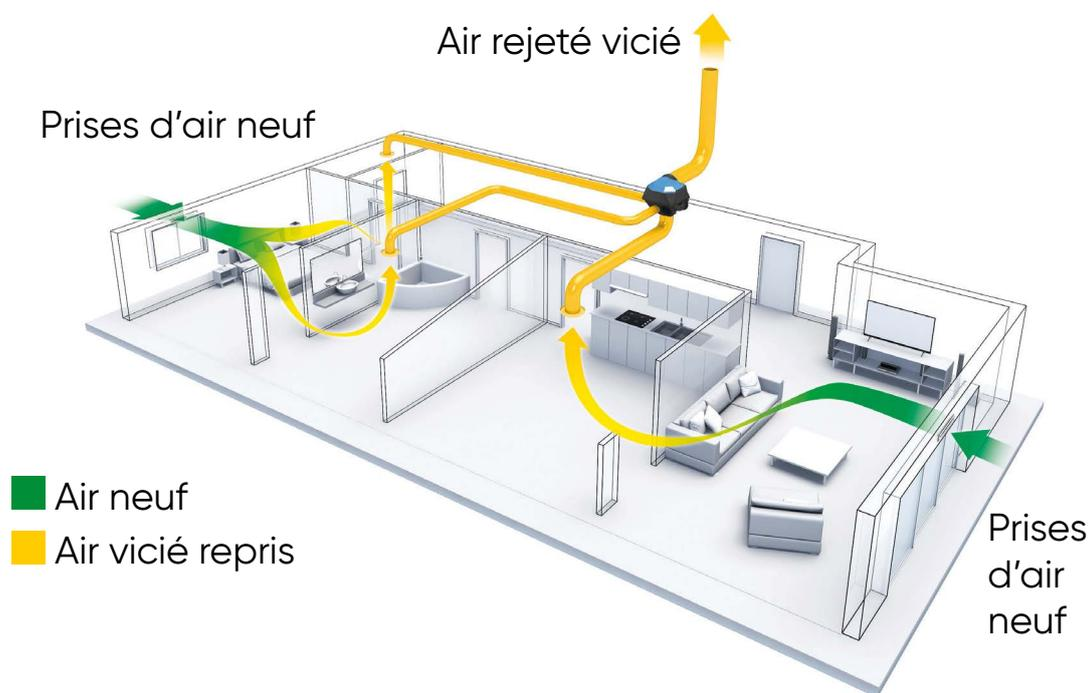
La Ventilation Mécanique Contrôlée (VMC) simple flux fonctionne avec plusieurs entrées d'air présentes dans vos pièces sèches (salon et chambres). Ensuite l'air vicié (pollué) est récupéré dans les pièces humides (salle de bain, toilette et cuisine) grâce à des bouches d'extractions et il est rejeté hors du logement. C'est le principe du balayage de l'air dans votre logement.
