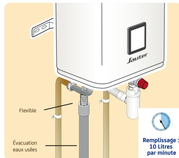
Ouvrez l'eau pour remplir le chauffe-eau et testez l'étanchéité. Pour un remplissage complet, ouvrez un robinet d'eau chaude pour purger l'air du chauffe-eau.
