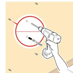
3 Fixez fermement l'étrier supérieur au mur. Utilisez des fixations de Ø 10 mm minimum
