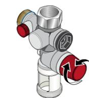
Manœuvrez régulièrement la soupape pour vérifier le bon fonctionnement et éviter l'entartement du système
