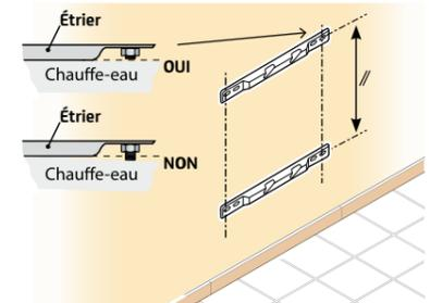
4 Levez puis posez votre chauffe-eau dans les encoches. Si la résistance du mur est suffisante la fixation par le seul étrier supérieur est possible. Dans ce cas, positionner l'étrier inférieur sur le chauffe-eau, les ouvertures dirigées vers le bas pour faire appui sur le mur.
