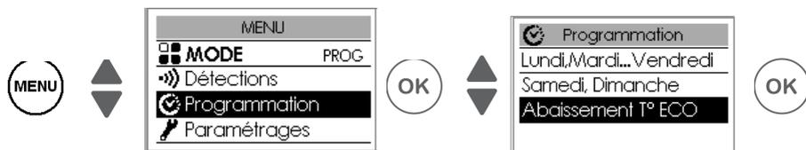
Permet de régler le niveau d'abaissement de la température que vous souhaitez effectuer en dehors des plages Confort (de  $-2^{\circ}\text{C}$  à  $-9^{\circ}\text{C}$ ). Par défaut, il est réglé  $-3,5^{\circ}\text{C}$  (si la température de consigne est réglée à  $19^{\circ}\text{C}$ , alors, en dehors des plages de Confort elle baissera jusqu'à  $15,5^{\circ}\text{C}$ ).
