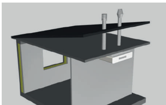
Configuration 1 avec aspiration et rejet en toiture
