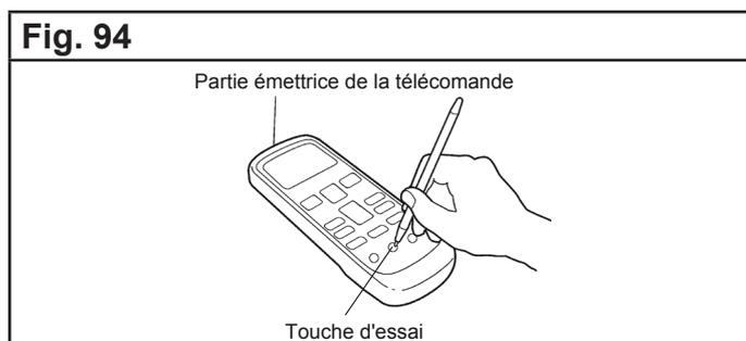
• Pour terminer l'essai, appuyez sur le bouton "START/STOP". (Lorsque le climatiseur est mis en marche avec la touche "TEST", les témoins "OPERATION" et "TIMER" clignotent simultanément lentement. Lors du démarrage les clignotements s'arrêtent.)
