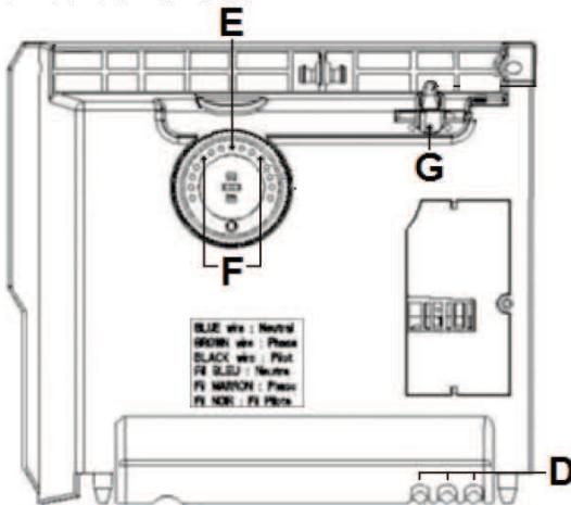
É possível limitar ou bloquear o uso do botão de controlo **C** e bloquear o interruptor **B**. Levante o aparelho do suporte da parede. Na parte de trás do termostato, retire os pinos **D**:
