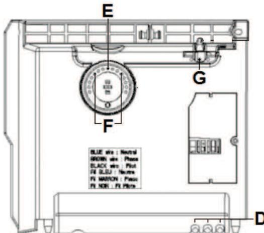
Aby uniknąć nieoczekiwanej zmiany ustawień, można zablokować lub ograniczyć ruch regulatora **Z** i zablokować suwak **B**. Aby to zrobić, należy zdjąć urządzenie z wspornika do montażu na ścianie. Na tylnej ściance obudowy termostatu, wyciągnąć kołki **D**:
