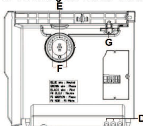
Um die unerwünschte Veränderung der Einstellungen zu vermeiden, kann man den Gang des Reglers C blockieren oder beschränken sowie den Mehrstellenschalter B blockieren. An dem hinteren Seite des Gehäuses von Thermostat ziehen Sie die Stifte D aus:
