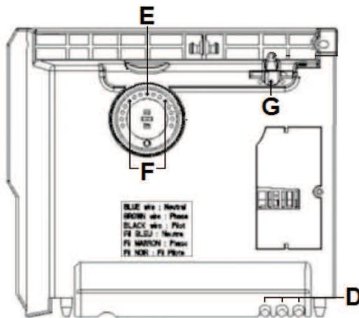
Για να αποφύγετε απροσδόκητες αλλαγές στις ρυθμίσεις, μπορείτε να κλειδώστε ή να περιορίσει το ρυθμιστή **C** και να κλειδώστε το **B**. Για να το κάνετε αυτό, αφαιρέστε τη μονάδα από τη βάση τοίχου. Στο πίσω μέρος του σώματος του θερμοστάτη, αφαιρέστε τις καρφίτσες **D**:
