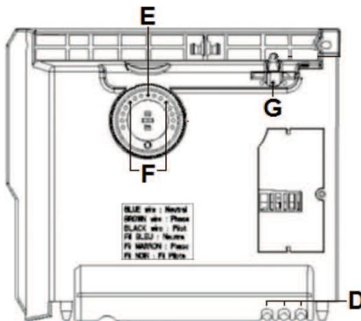
Il est possible de bloquer ou de limiter l'utilisation de la molette C et de bloquer le curseur B pour empêcher les manipulations. Décrocher l'appareil de son support mural. Sur le dos du boîtier thermostat, détacher les pions D de leur support :
