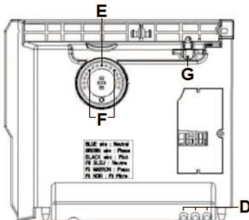
Para evitar el cambio inesperado de ajustes, se puede bloquear o limitar el paso del regulador **C** y bloquear el cursor **B**. para ello hay que quitar el aparato del soporte de pared. En la parte trasera del cuerpo del termostato saque los pasadores **D**:
