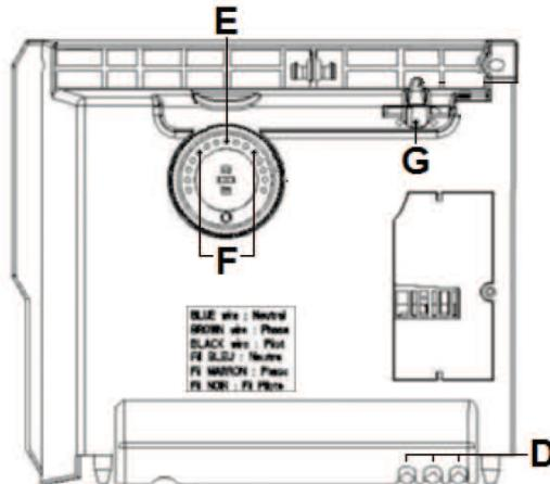
Во избежание непредвиденного изменения настроек, можно заблокировать или ограничить ход регулятора **C** и заблокировать бегунок **B**. Для этого снимите прибор с настенного кронштейна. На тыльной стороне корпуса термостата вытяните штифты **D**:
