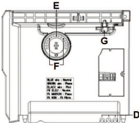
Щоб уникнути непередбаченої зміни настроювань, можна заблокувати або обмежити хід регулятора С й заблокувати бігунок В. Для цього, зніміть прилад з настінного кронштейна. На тильній стороні корпусу термостата, витягніть штифти D:
