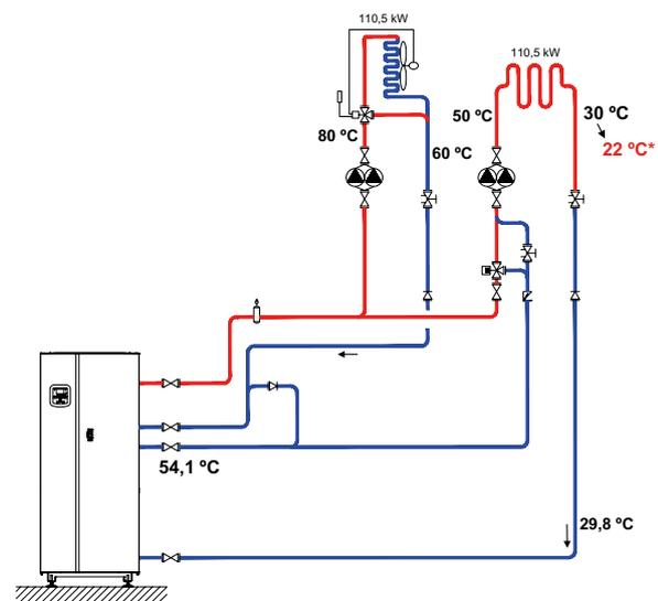
\* La temperatura de retorno varía en función de la temperatura externa.
