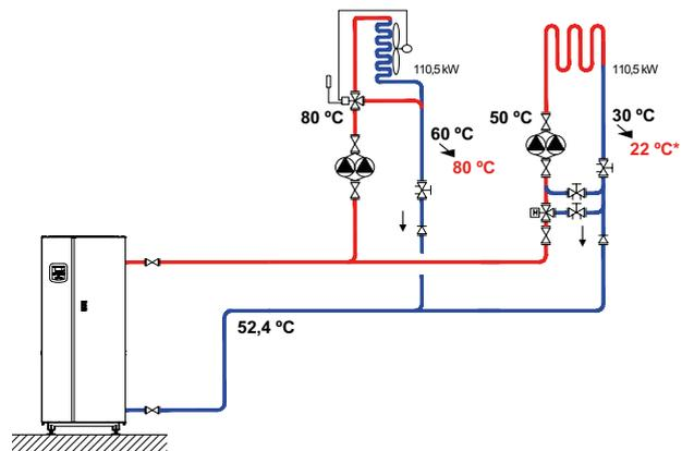
\* La temperatura de retorno varía en función de la temperatura externa.
