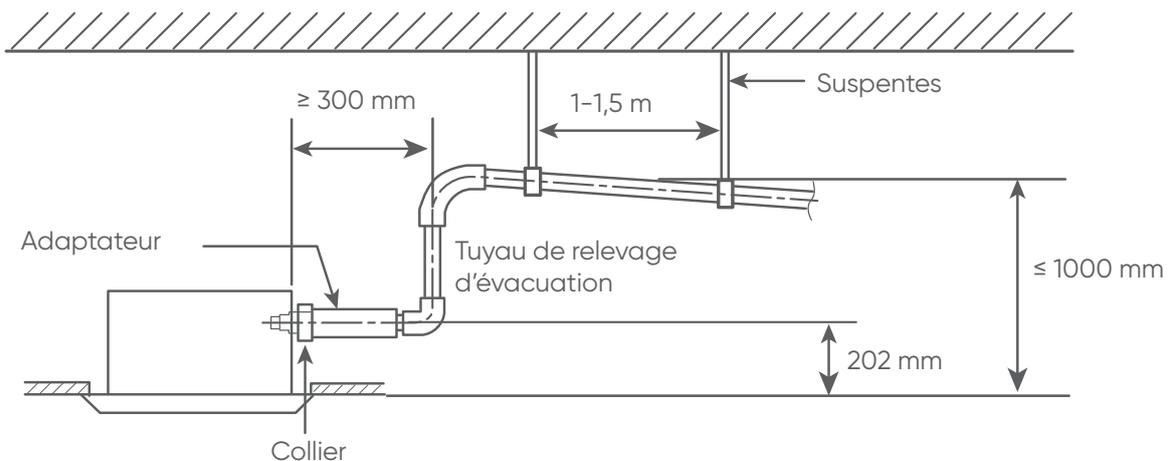
La pente du tuyau d'évacuation des condensats doit être 75 mm maximum pour que la sortie d'évacuation ne doivent pas nécessairement supporter une résistance excessive.
