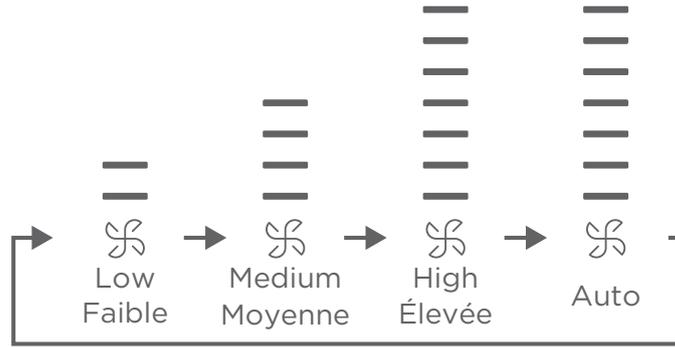
Le ventilateur de l'unité fonctionne à la vitesse de ventilation sélectionnée. Lorsque le réglage est sur AUTO, l'unité ajuste automatiquement la vitesse de ventilation en fonction de la température de la pièce.
