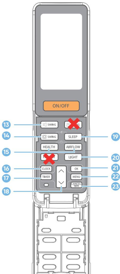
13. Bouton SWING haut-bas (Sélectionner l'orientation du flux d'air)
