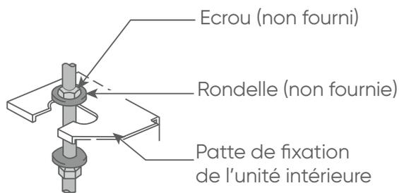
Erou et contre-écrou serrés (sécurisation de la fixation)
