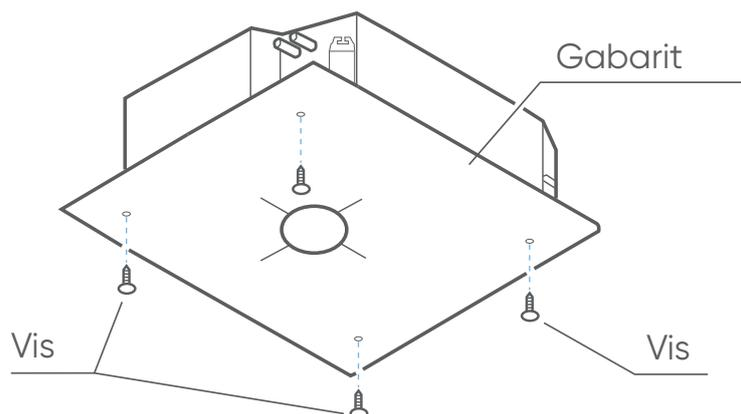
3. Après l'installation au faux-plafond, ajuster l'unité pour une installation conforme (voir paragraphe "4.1 Ouverture plafond et fixations" page 15).
