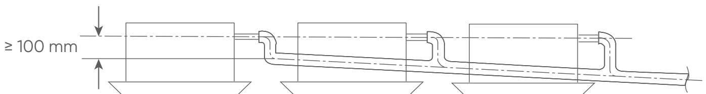
La taille du tuyau doit être adaptée à la capacité des unités.
