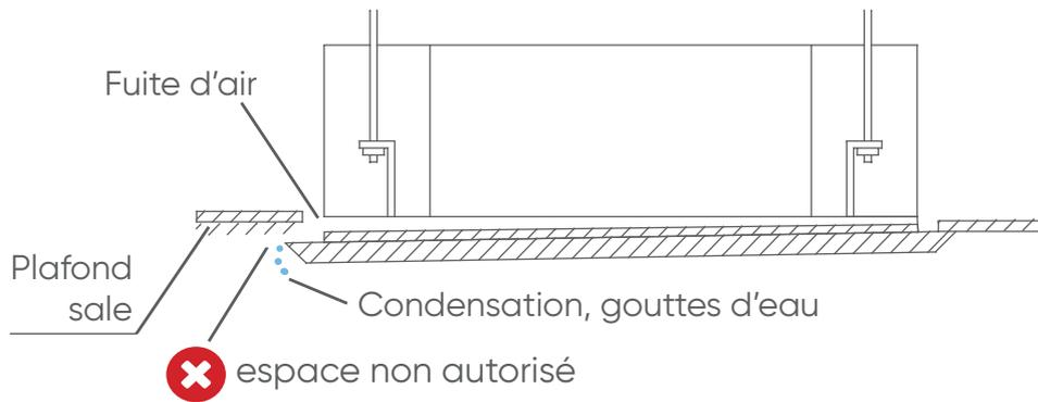
Après serrage des vis, s'il y a un espace entre la façade et le faux-plafond, réajuster la hauteur de l'unité intérieure.
