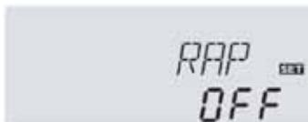
Permet d'activer l'appoint électrique en marche forcée même en dehors de la ou des plages de fonctionnement autorisée(s) lorsque l'utilisateur a des besoins en eau chaude imprévus importants. Retour automatique dans le mode précédent une fois la chauffe effectuée.
