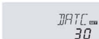
Durée de fonctionnement du circulateur à 100% de son régime lors des phases de démarrage. L'anti court cycle a pour fonction de mettre en mouvement le glycol contenu dans le circuit solaire et de stabiliser la température afin d'éviter les marches/arrêts intempestifs de la pompe.
