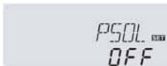
Priorise le fonctionnement solaire lorsque la pompe est en fonctionnement normal (hors mode MANU et BOOST) et arrête l'appoint électrique même s'il doit fonctionner (c'est-à-dire qu'on se trouve sur une plage horaire de fonctionnement de l'appoint électrique).
