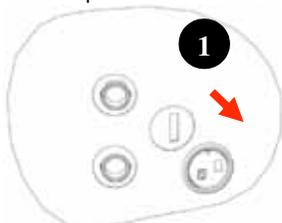
Retirer le bouchon du logement de situé à côté de l'échangeur interne.
