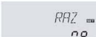
Remise à zéro des informations affichées : le nombre d'heures de fonctionnement de la pompe solaire et le de l'appoint électrique [HP1] / [HP2] et du gain énergétique [KWh], [MWh].
