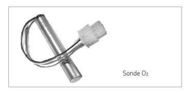
Par la régulation permanente de l'excès d'air dans les fumées, la condensation est optimisée et le rendement peut être augmenté de jusqu' à 3,5 %, parce que le point de rosée des fumées est plus élevé lorsque l'excès d'air est très faible et que la condensation se poursuit sur une plus longue durée.
