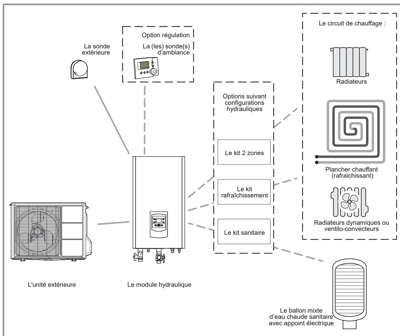
figure 1 - Vue d'ensemble d'une configuration d'installation complète
