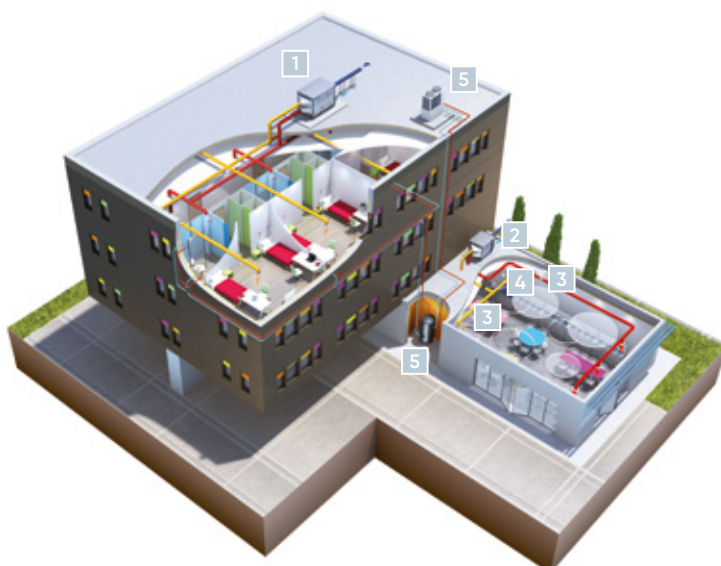
1 Centrale double flux à échangeur à contre courant très haut rendement DUOTECH C4
