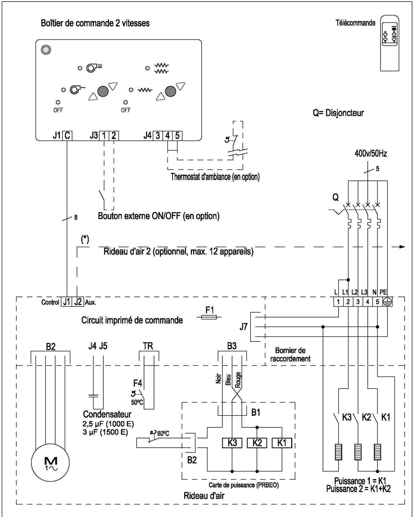
**Schéma de raccordement 400 V – 3 N pour l'appareil longueur 2000 mm :**
