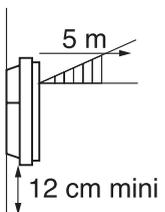
La détection ne se fait pas en dessous du capteur.
