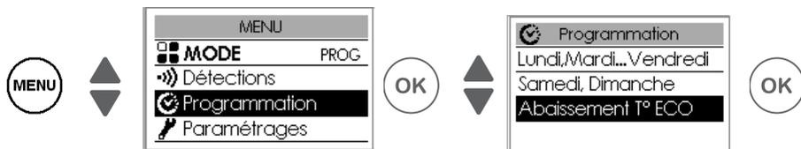
Permet de régler le niveau d'abaissement de la température que vous souhaitez effectuer en dehors des plages Confort (de -2°C à 9°C). Par défaut, il est réglé -3,5°C (si la température de consigne est réglée à 19°C, alors, en dehors des plages de Confort elle baissera jusqu'à 15,5°C).
