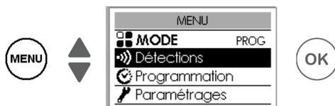
Par défaut, la fonction détection d'occupation est inactive et la fonction détection fenêtre ouverte est active (voir chapitre "Fonctions Détections").
