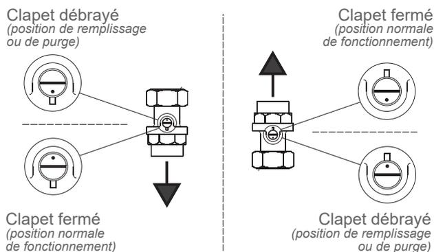
fig. 6 - Clapets anti-retour
