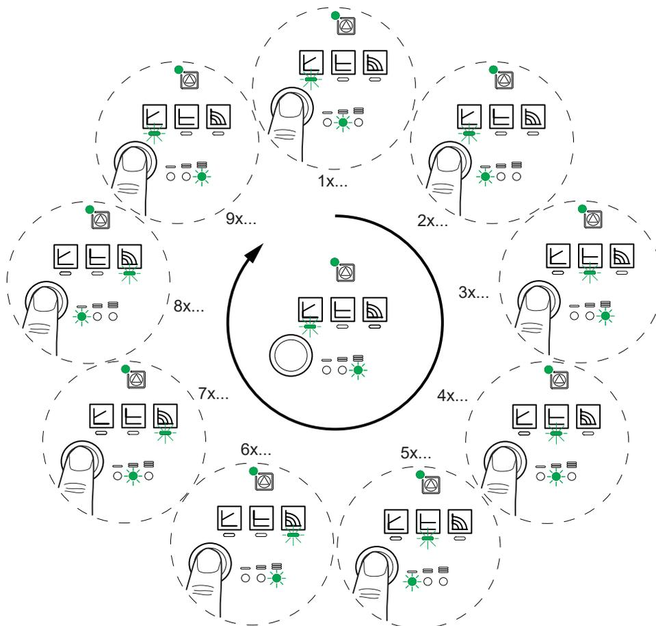
fig. 12 - Réglage du circulateur
