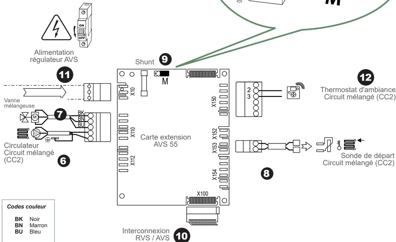
fig. 5 - Raccordements électriques sur carte extension AVS 55
