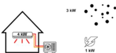
NISEKO est une pompe à chaleur air-air. Elle peut être utilisée à la fois pour chauffer et pour rafraîchir. Sa principale source d'énergie est celle de l'air extérieur, une énergie gratuite et inépuisable. Pour pouvoir prélever cette énergie, elle a besoin d'une énergie secondaire : l'électricité. Elle utilise en moyenne 1kW d'électricité pour restituer jusqu'à 4kW d'énergie dans une pièce.
