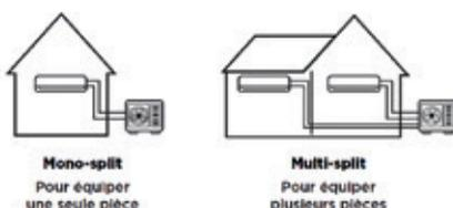
Les unités intérieures NISEKO peuvent s'associer à des unités extérieures mono-split pour chauffer et rafraîchir une seule pièce, ou à des unités extérieures dites multi-split pour chauffer et rafraîchir plusieurs pièces selon les besoins. Jusqu'à 5 unités NISEKO peuvent être installées sur une seule unité extérieure multi-split Thermor.
