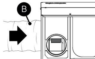
6. Recouvrir le piquage avec l'isolant (B).
