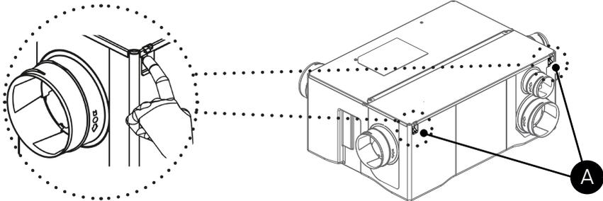
1. Appuyer sur les 2 boutons poussoirs (A) afin de déverrouiller le capot.
