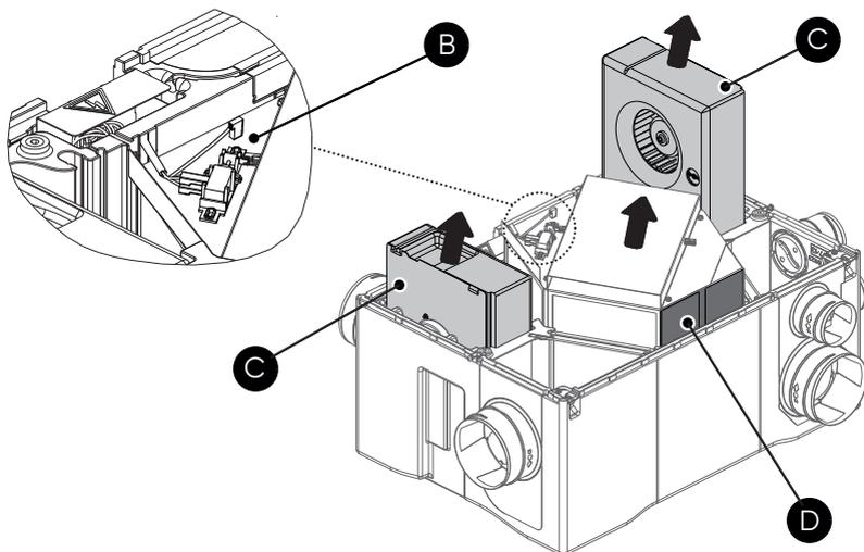
3. Débrancher les 3 cosses du faisceau avant de retirer l'ensemble BY-PASS/échangeur (B).
