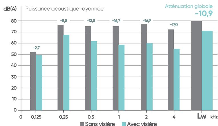
Exemple d'atténuation acoustique pour un point de fonctionnement à 2 000 m<sup>3</sup>/h et 200 Pa.
