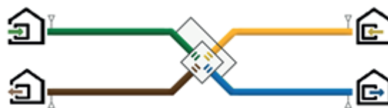
Échangeur à plaques à contre-courant
