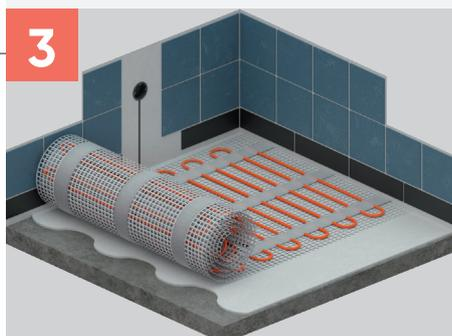
Raccorder le récepteur à la trame, puis disposer le câble chauffant sur le sol en suivant le plan de calepinage.
