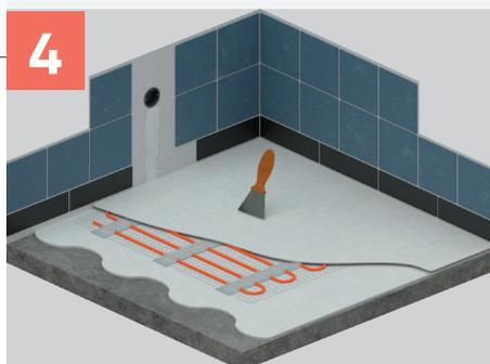
Il est recommandé de réaliser un ragréage pour recouvrir le câble avant de poser le revêtement définitif.
