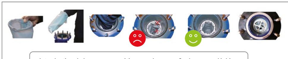
Introduction du barreau magnétique en douceur afin de ne pas déchirer la poche en frottant sur les parois avec l'anneau inférieur.
