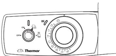
Autre exemple : La molette **D** est positionnée sur 21° C. La température affichée sur votre thermomètre est de 18°C. La valeur d'étalonnage sera donc de -3°C (3 crans).
