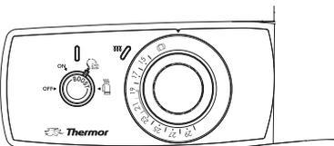
Beträgt der Kalibrierwert  $+3^{\circ}\text{C}$ , liegt der Anschlag des Einstellrades auf  $15^{\circ}\text{C}$ , aber Sie erhalten dennoch eine Frostschutz-Temperatur von  $7^{\circ}\text{C}$ .
