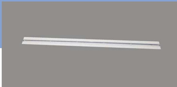
Les diffuseurs linéaires invisibles de la série LOOK ont été conçus pour combiner esthétique et performances techniques. Son installation se fait en plafond ou au mur. Le cadre pourra être recouvert de mastic afin de ne laisser visible que la fente. Une ligne continue de LOOK peut être formée grâce aux versions « avec » ou « sans » pièces d'extrémités.
