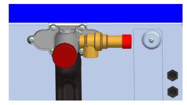
**Figure 4.9 Safety Relief Valve Position**
