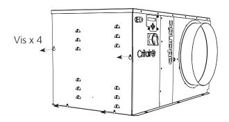
Pour accéder au bornier et à la carte électronique, desserrer les quatre vis, faire glisser de 10 mm le capot vers le haut et tirer le bas du capot pour l'ouvrir.
