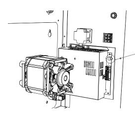
Sélection de vitesses : l'appareil est câblé d'usine sur V4. Lors d'une sélection de vitesse la LED rouge clignote X fois (ex : vitesse 4=4 clignotements).
