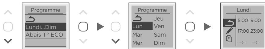
Vous pouvez programmer jusqu'à 3 plages de température « Confort » pour chaque jour de la semaine. En dehors de ces plages, l'appareil effectue un abaissement de température [réglé par défaut à -3,5°C].
