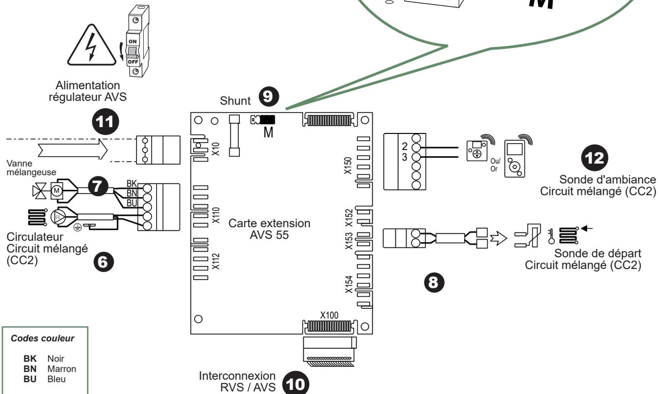
fig. 5 - Raccordements électrique sur carte extension AVS 55
