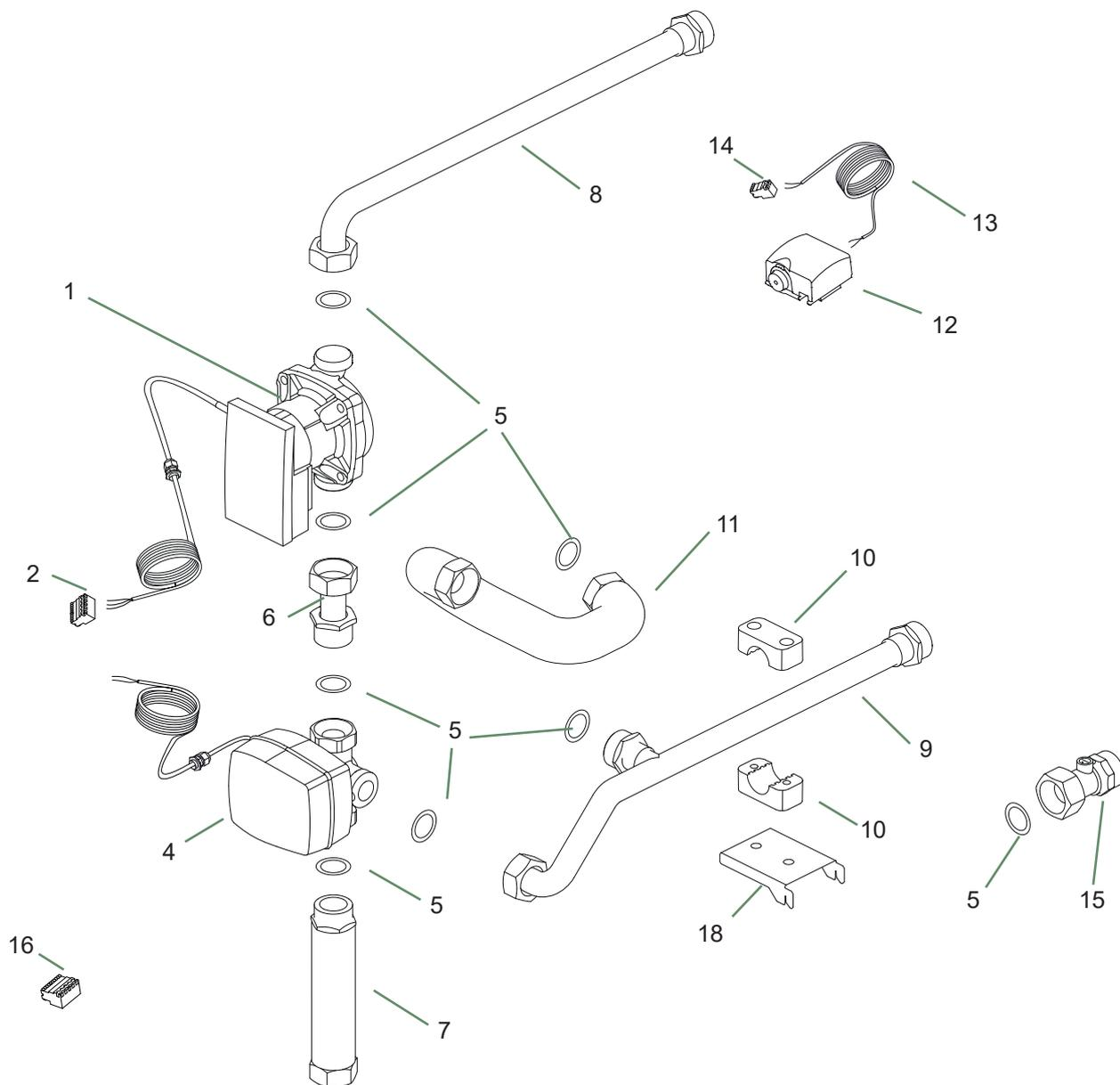
fig. 7 - Pièces détachées kit 2 circuits
