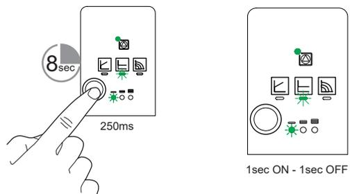
fig. 12 - Verrouillage & déverrouillage des réglages du circulateur
