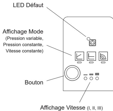
fig. 8 - Affichage sur le boîtier circulateur
