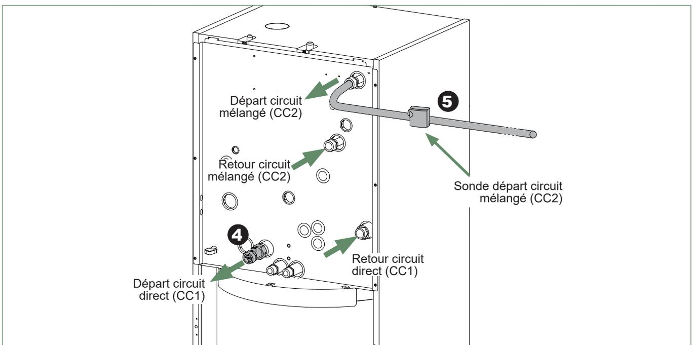
fig. 4 - Montage du kit hydraulique
