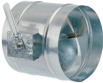
• Registre 125 (à commande manuelle) Il permet l'équilibrage des débits Il permet de compenser un éventuel déséquilibre A installer sur le réseau d'insufflation
