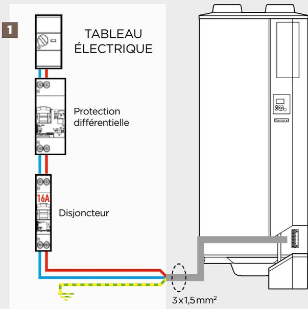
Afin d'assurer la protection contre la corrosion de la cuve, **le chauffe-eau doit être alimenté en permanence.**
