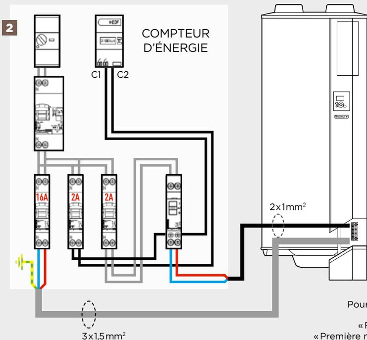
Pour que le fonctionnement heures creuses / heures pleines soit actif, régler la plage de fonctionnement dans le menu des paramètres. (voir section « Première mise en service » de votre notice).
