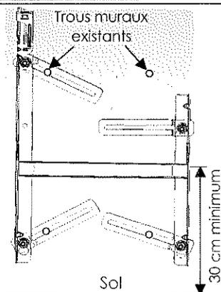
④ Sur un support plat, serrer modérément les 4 brides **(A)** (à l'aide des écrous **(B)** et des vis **(C)**) sur chacun des trous du support mural (selon **Config 1** ou **2** de votre choix).
