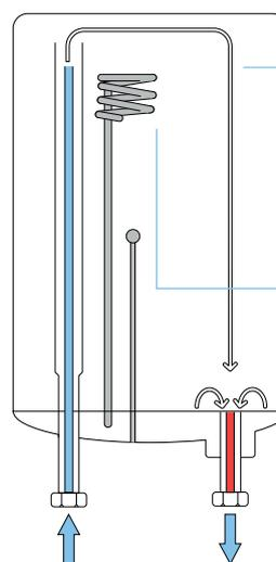
Le chauffe-eau ne peut pas se remplir car l'arrivée d'eau se retrouve en haut et la sortie en bas
