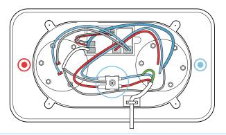
III. A l'aide d'une pointe de crayon ou d'un tournevis fin, appuyer légèrement sur le bouton rouge au centre
