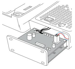
ETAPE 5 : débrancher le connecteur d'alimentation et le connecteur audio.
