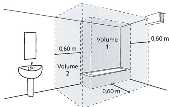
Si les dimensions de la salle de bain ne permettent pas de placer le chauffe-eau hors volumes 1 et 2 :
