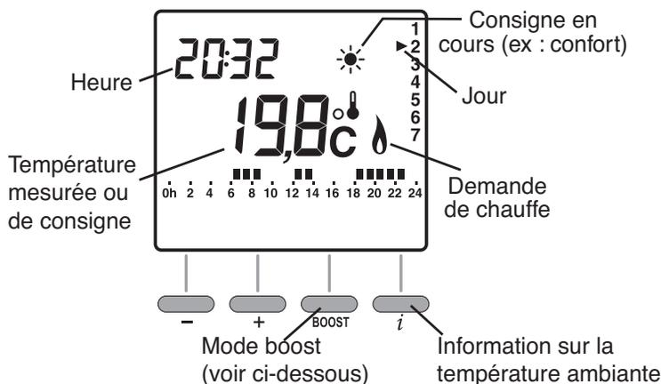
A la mise en service, la température de consigne s'affiche (le symbole apparaît au-dessus du °C indiquant que c'est la température mesurée).
